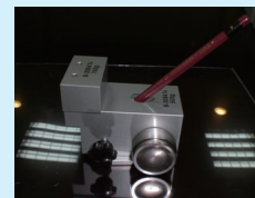
Hardness Test (JIS-K5600)
